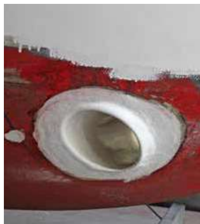
Aanpassing aan hedendaagse techniek: een boegschroef.
